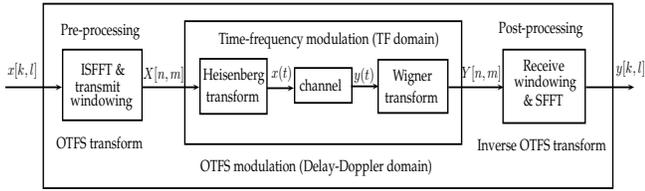
Fig. 1: OTFS modulation scheme.
